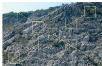
Fig. 5.1.3.3. Zonas de muestreo de la superficie para el control fotográfico del recubrimiento vegetal en taludes rocosos o acantilados.
